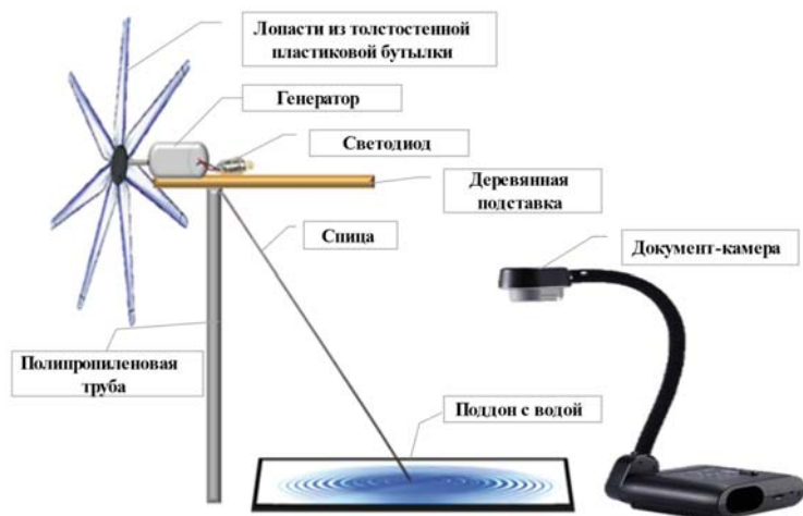
Рис. 2. Схема модели ветрогенератора с механизмом диагностики колебаний
